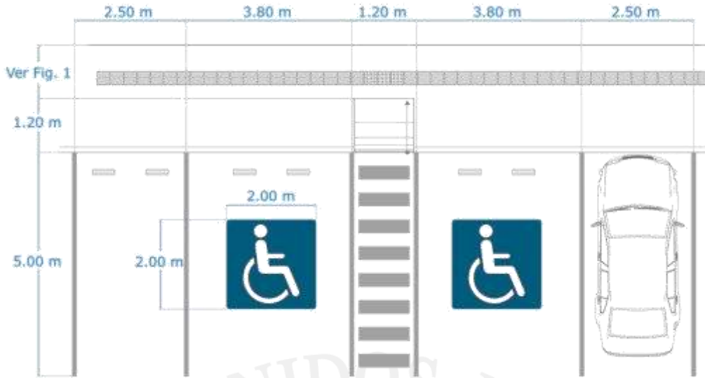
Figura 28 - Estacionamiento en batería
